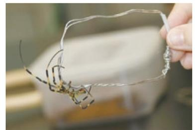
クモを金枠から落下させ、糸を5m巻き取る
