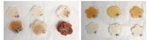
耐熱性の検証。電子レンジで加熱したもの(左写真)より、天日干ししたもの(右写真)のほうがよい結果となった
